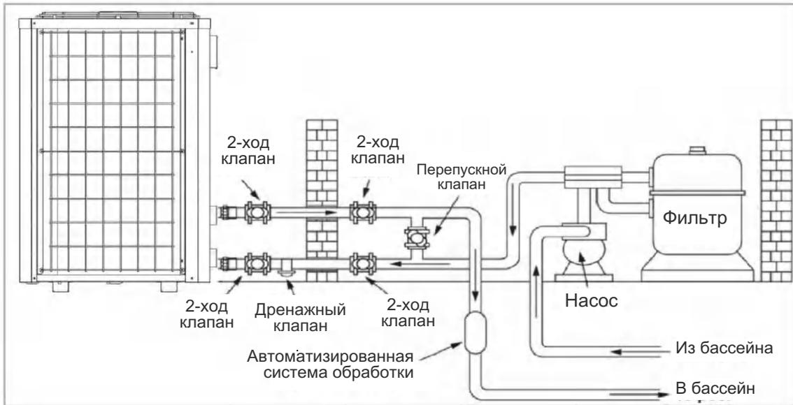
Тепловой насос подключен к фильтрующему контуру с перепускным клапаном. Перепускной клапан должен быть приоткрыт (дресселирован), в то время как все остальные клапаны должны быть открыты полностью. Мы рекомендуем наполовину открыть перепускной клапан, чтобы избежать чрезмерного давления на тепловой насос.
